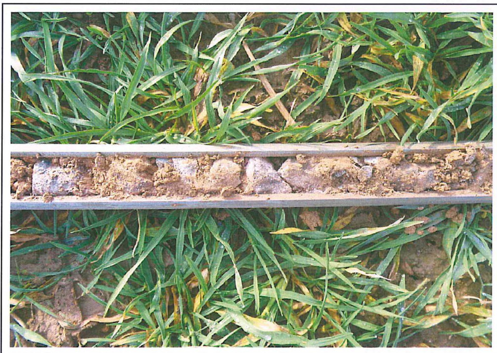
Foto 2: Detail aus Bohrung BS 1: Hangschutt (Felsreste in lehmiger Matrix)
