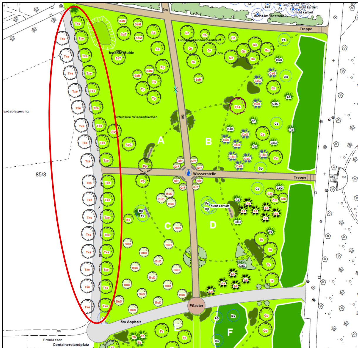
Abb. 5: Ausschnitt aus dem Vorentwurf der Zielplanung für die Erweiterung des Hauptfriedhofes mit der Anlage einer Allee gemäß Maßnahme M2 (rot)
