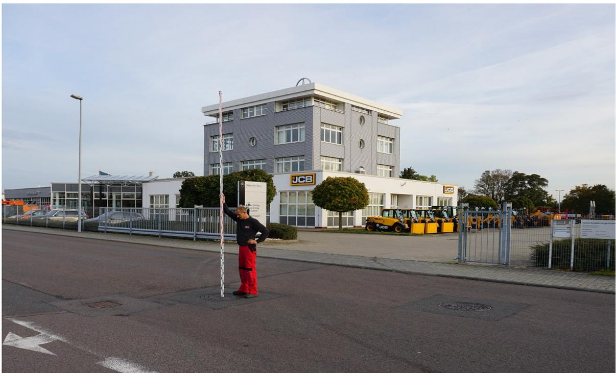
**Bild 3: Höhenbezugspunkt (HBP) = Oberkante Kanaldeckel (OK KD) =  $\pm 0,00$  m = 114,42 m NHN**
