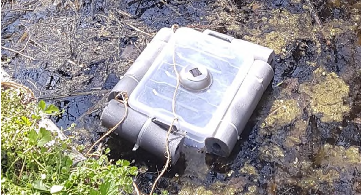
Abb. 5: Trichter-Lichtfalle für die Erfassung von Molchen
