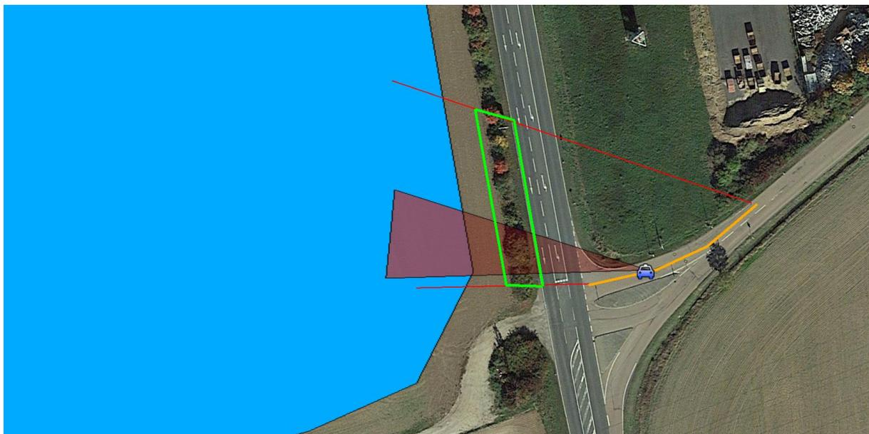
Abbildung 17: Streckenabschnitt auf der Straße Apfelborn auf welchem Reflexionen im relevanten Sichtfeld der Verkehrsteilnehmer auftreten, in Orange, Reflexionen auf die Verkehrsteilnehmer in Rot, bestehende Sichtunterbrechung durch Gehölz in Grün (Quelle: Google Earth)
