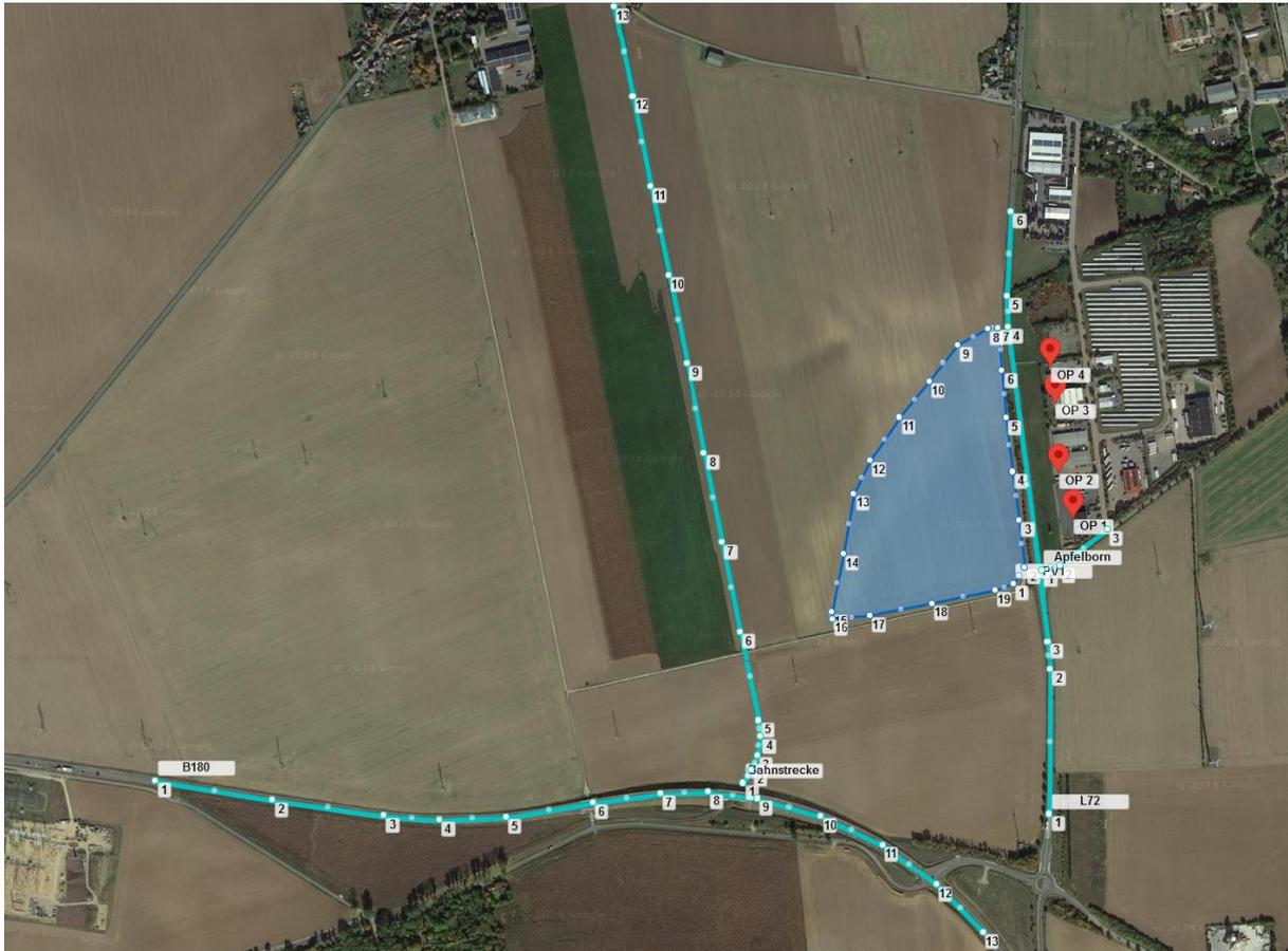
Abbildung 11: Anlage und Immissionsorte in der Simulationssoftware ForgeSolar
