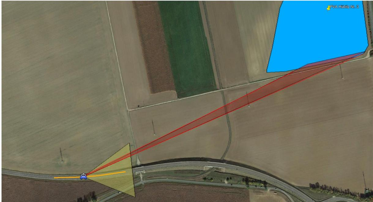
Abbildung 13: Streckenabschnitt auf der B180, auf welchem Reflexionen im relevanten Sichtfeld der Verkehrsteilnehmer auftreten, in Orange, relevantes Sichtfeld Verkehrsteilnehmer in Gelb, Reflexionen auf die Verkehrsteilnehmer in Rot (Quelle: Google Earth)
