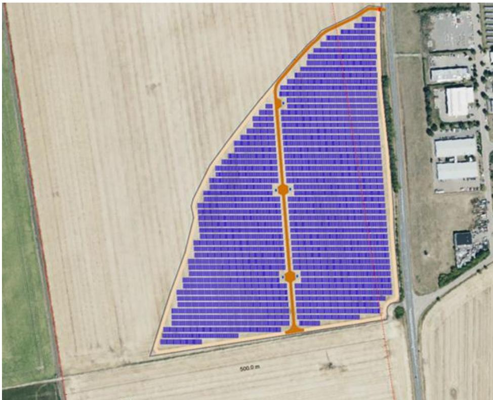
Abbildung 2: Modulbelegungsplan (Quelle: Auftraggeber)
