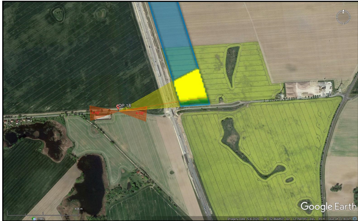
Abbildung 7b: Blendungsmöglichkeiten des Fahrzeugführers am Immissionsort OP 18 (Gemeindestraße „Stöffin-Buskow“) bei Vorbeifahrt in Ost- bzw. Westrichtung. Rote Bereiche: relevante Blickwinkel ( \pm 15^\circ ) des Fahrzeugführers. Gelbe Bereiche: immissionsort-spezifische Blendwinkel des Modulfeldes.
