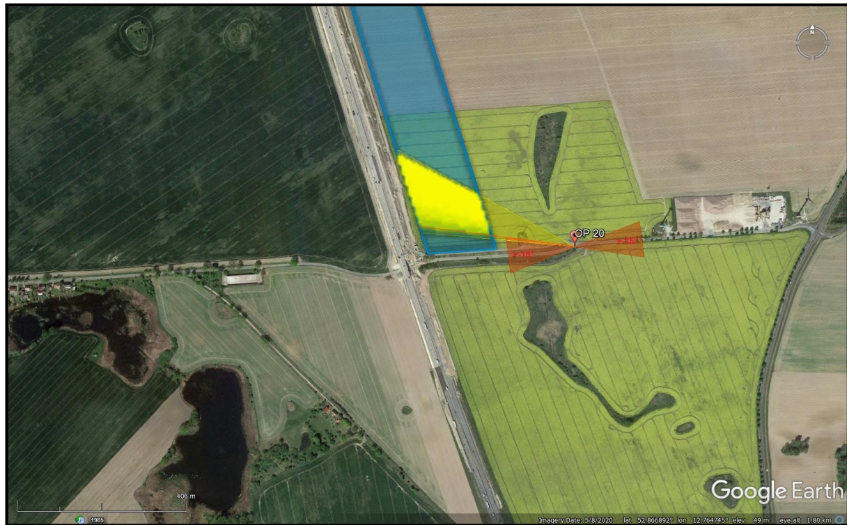
Abbildung 7d: Blendungsmöglichkeiten des Fahrzeugführers am Immissionsort OP 20 (Gemeindestraße „Stöffin-Buskow“) bei Vorbeifahrt in Ost- bzw. Westrichtung. Rote Bereiche: relevante Blickwinkel ( \pm 15^\circ ) des Fahrzeugführers. Gelbe Bereiche: immissionsort-spezifische Blendwinkel des Modulfeldes.
