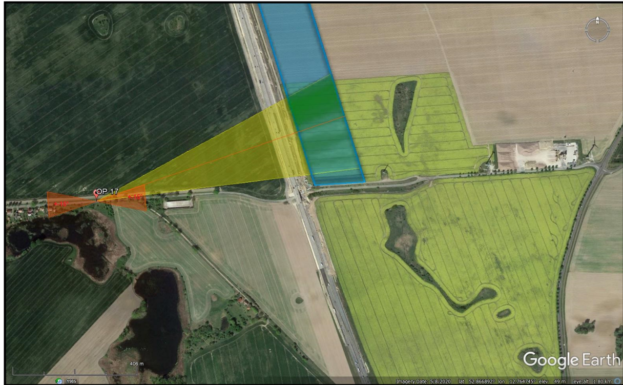
Abbildung 7a: Blendungsmöglichkeiten des Fahrzeugführers am Immissionsort OP 17 (Gemeindestraße „Stöffin-Buskow“) bei Vorbeifahrt in Ost- bzw. Westrichtung. Rote Bereiche: relevante Blickwinkel ( \pm 15^\circ ) des Fahrzeugführers. Gelbe Bereiche: immissionsort-spezifische Blendwinkel des Modulfeldes.
