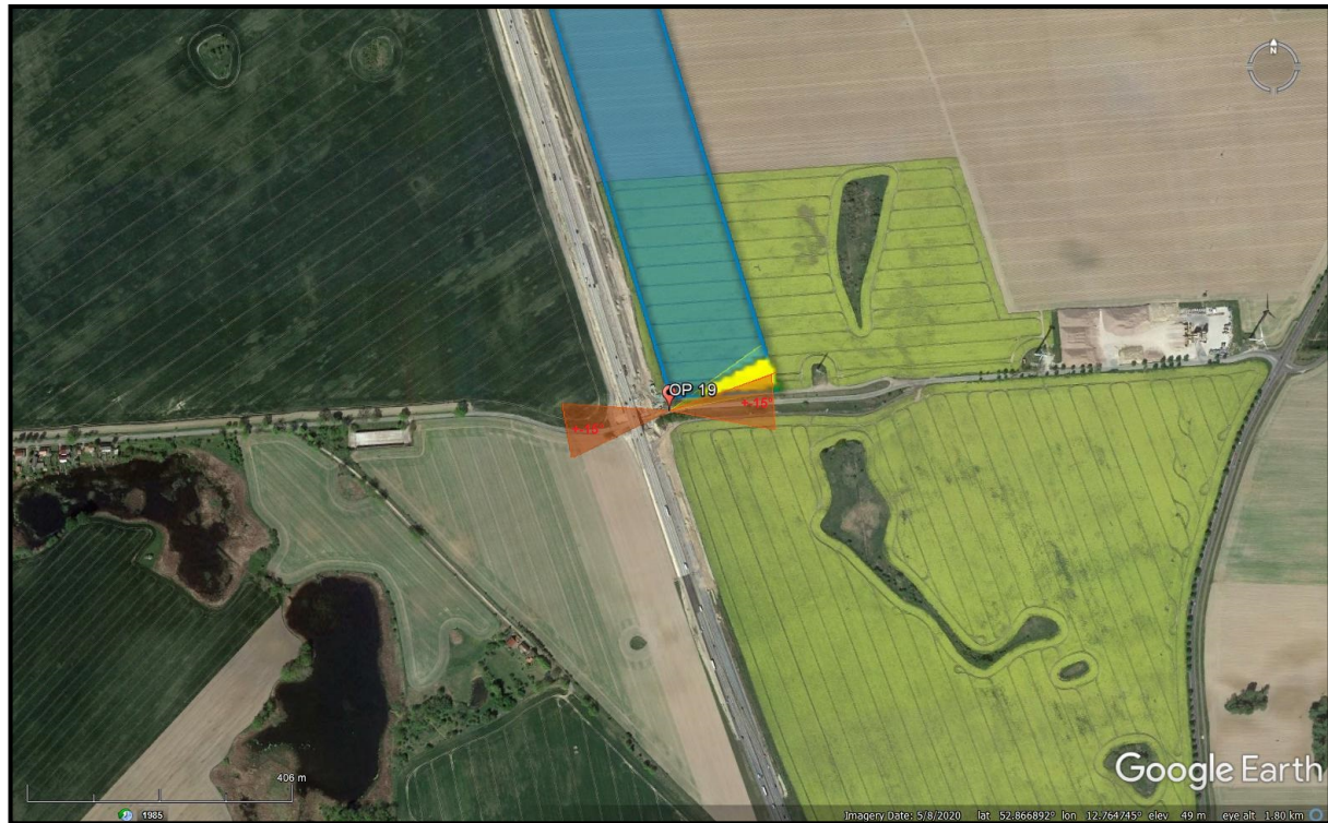
Abbildung 7c: Blendungsmöglichkeiten des Fahrzeugführers am Immissionsort OP 19 (Gemeindestraße „Stöffin-Buskow“) bei Vorbeifahrt in Ost- bzw. Westrichtung. Rote Bereiche: relevante Blickwinkel ( \pm 15^\circ ) des Fahrzeugführers. Gelbe Bereiche: immissionsort-spezifische Blendwinkel des Modulfeldes.
