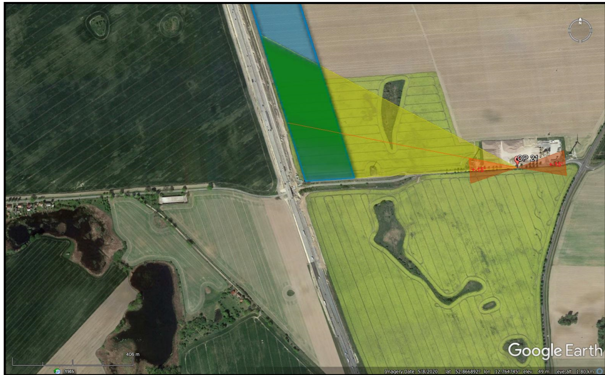
Abbildung 7e: Blendungsmöglichkeiten des Fahrzeugführers am Immissionsort OP 21 (Gemeindestraße „Stöffin-Buskow“) bei Vorbeifahrt in Ost- bzw. Westrichtung. Rote Bereiche: relevante Blickwinkel ( \pm 15^\circ ) des Fahrzeugführers. Gelbe Bereiche: immissionsort-spezifische Blendwinkel des Modulfeldes.
