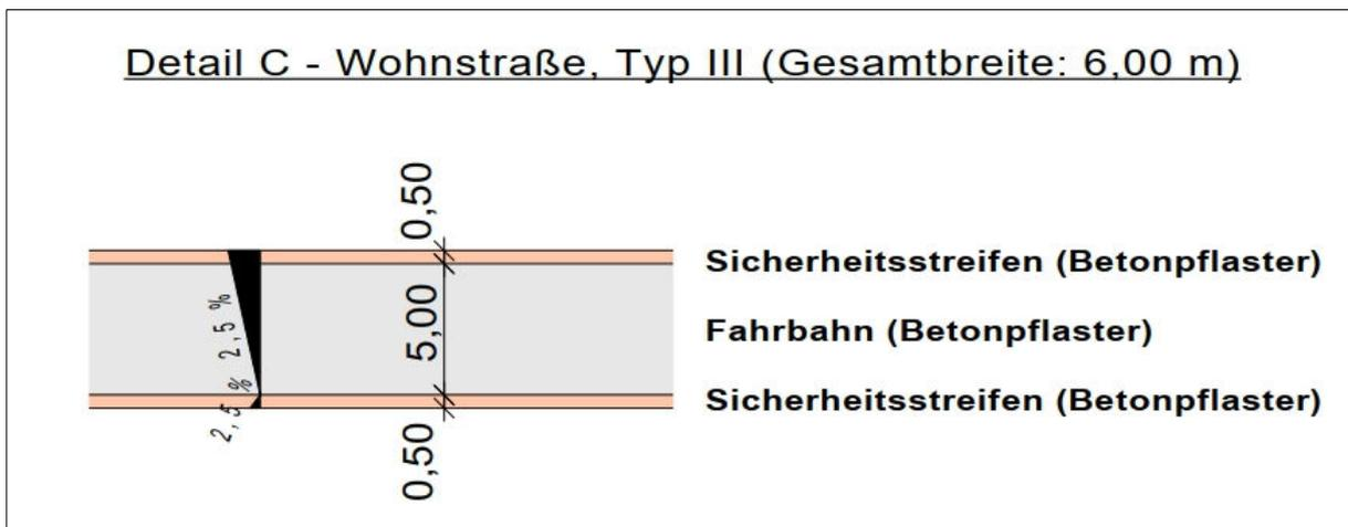
Abb. 11: Geplanter Querschnitt der Planstraße C
