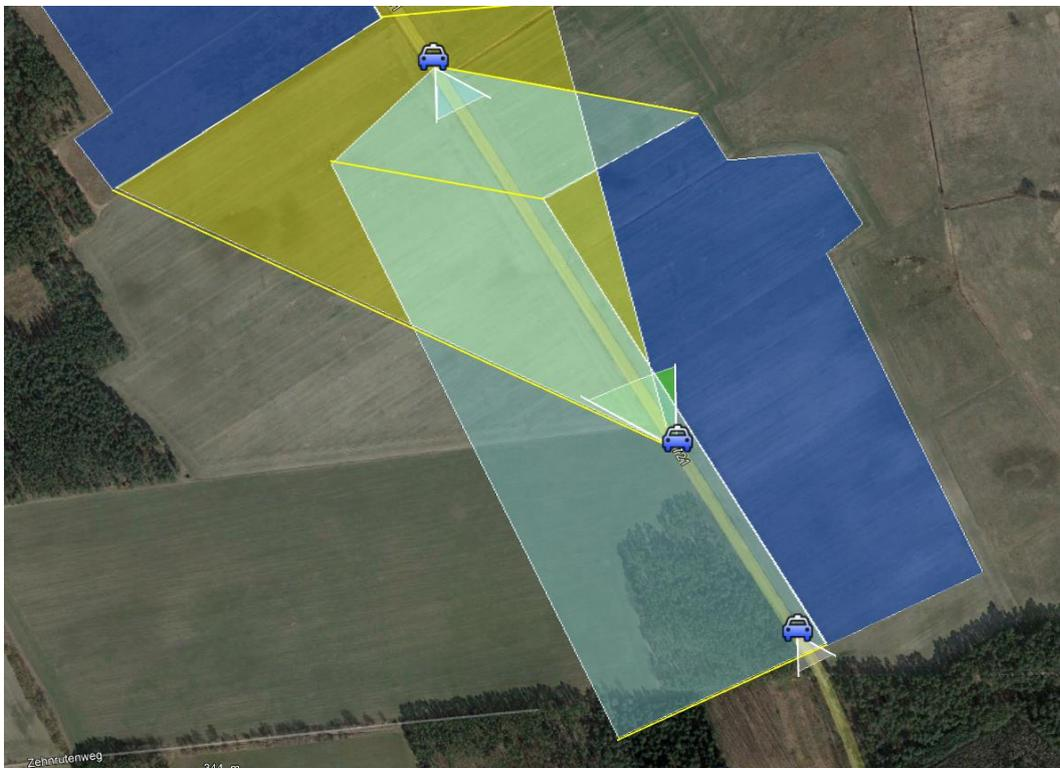
Abbildung 13: Emissionswinkel der TF2 und Immissionswinkel der Straßenverkehrsteilnehmer
