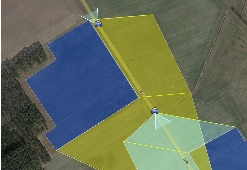
Abbildung 12: Emissionswinkel der TF1 und Immissionswinkel der Straßenverkehrsteilnehmer
