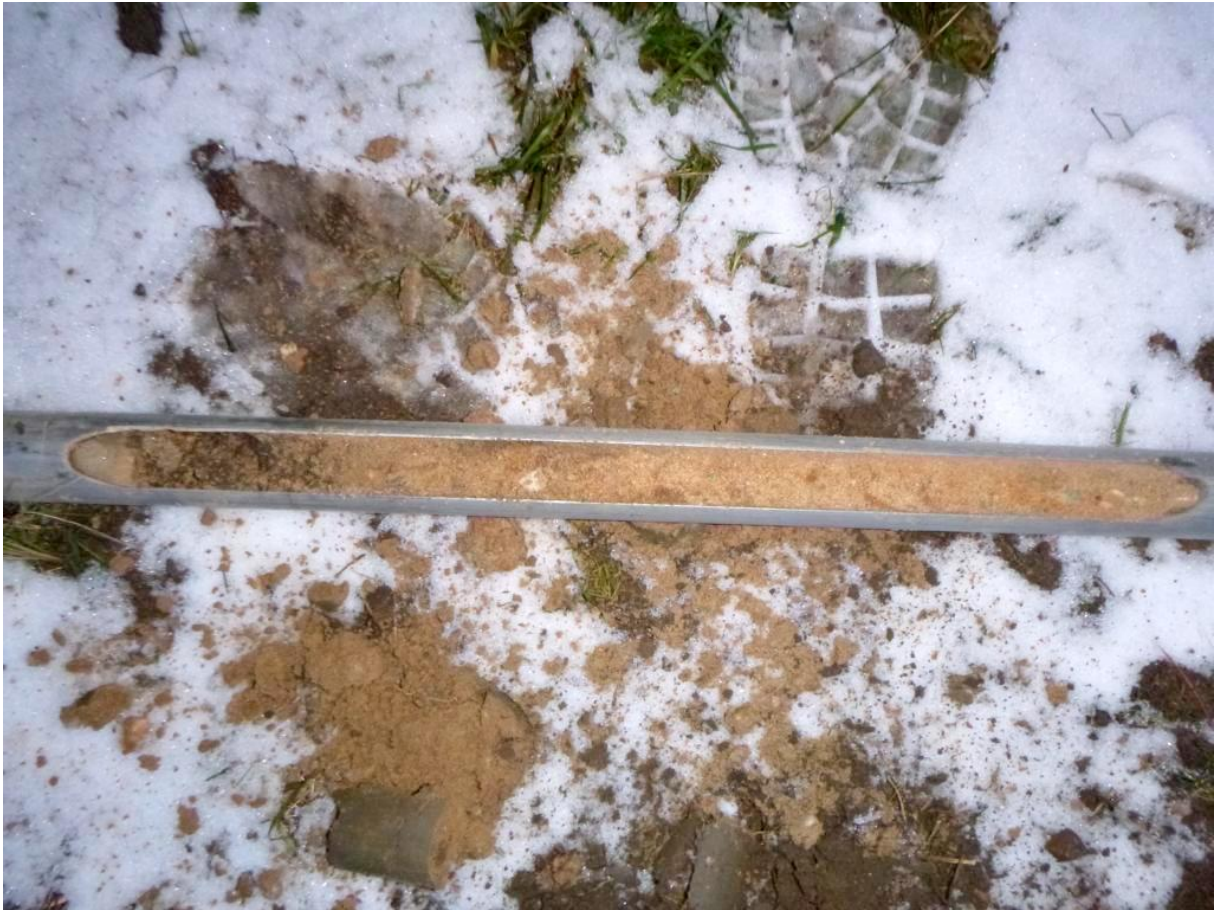
Bild 5: Westlicher Teil Versickerung, Feinsand, stark mittelsandig, Bereich bei 1,0-1,5 m.
