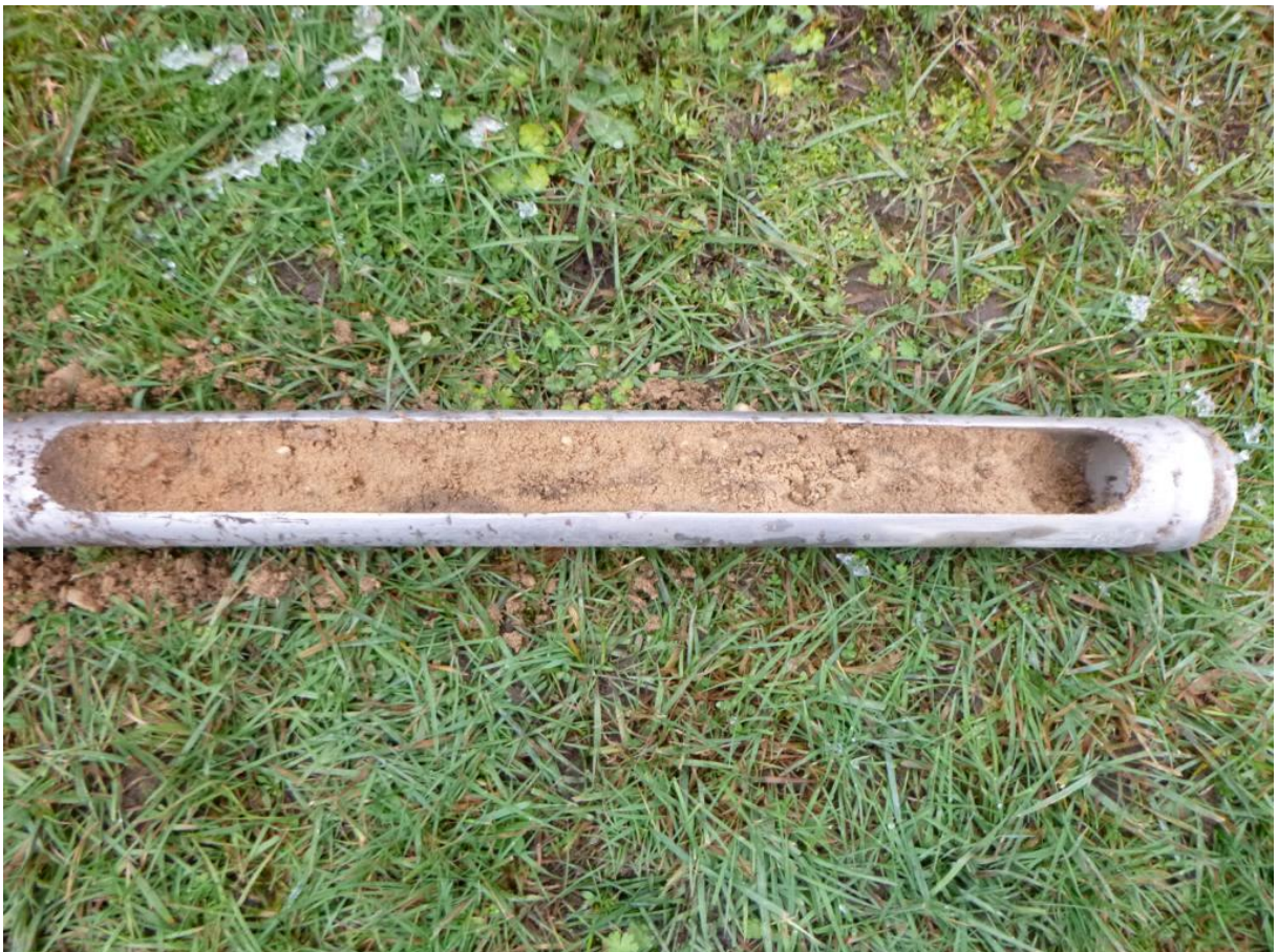
Bild 4: SW-Ecke, Mittelsand, feinsandig, schwach schluffig, Bereich bei 0,5-1,0 m.
